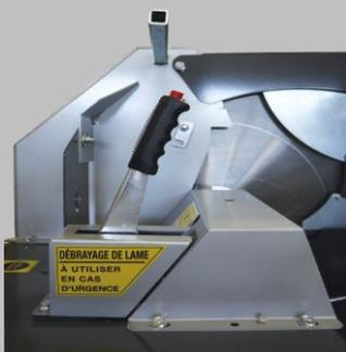
Débrayage de lame
