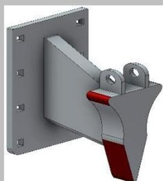
Avec le nouveau coin à profil éclateur les frottements sont limités, la bûche est attachée avec la pointe et écartée ensuite avec la partie supérieure élargie sans que la pointe ne frotte.
