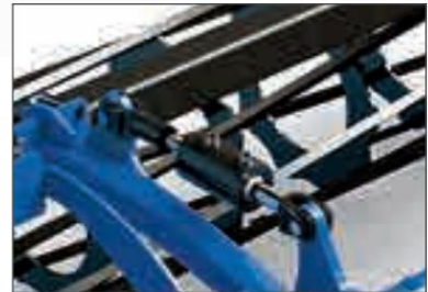
Réglage hydraulique de la profondeur de travail depuis la cabine par vérin émetteur/récepteur (option).
